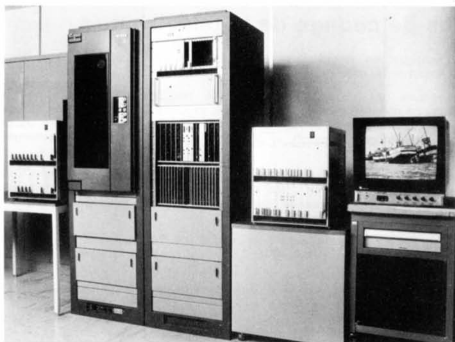
SYSTÈME EXPÉRIMENTAL D'ENREGISTREMENT NUMÉRIQUE D'IMAGES DE TÉLÉVISION
