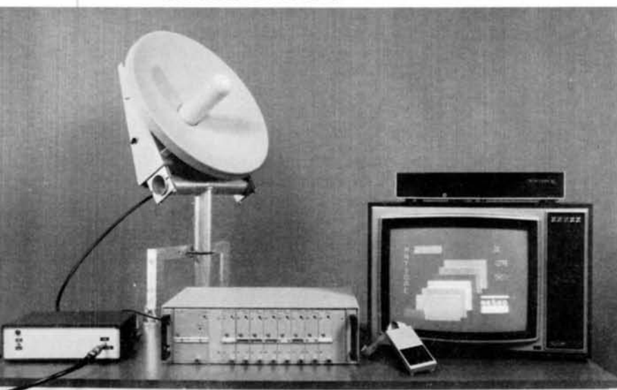
LIAISON EXPÉRIMENTALE A 12 GHZ FONCTIONNANT AVEC UN DES CANAUX UTILISÉ POUR LA TRANSMISSION DU SERVICE ANTIOPE
