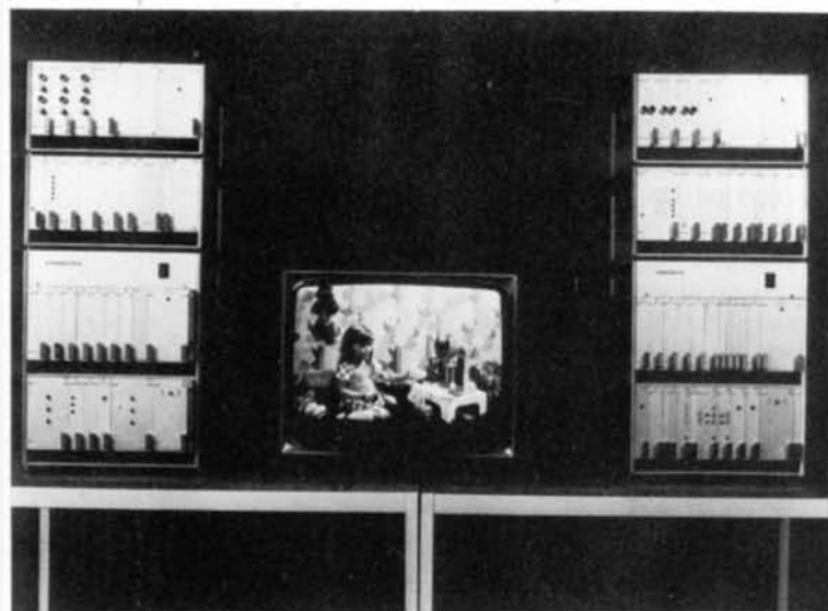
SYSTÈME EXPÉRIMENTAL DE TRANSMISSION NUMÉRIQUE D'UN MULTIPLEX IMAGE-SON
