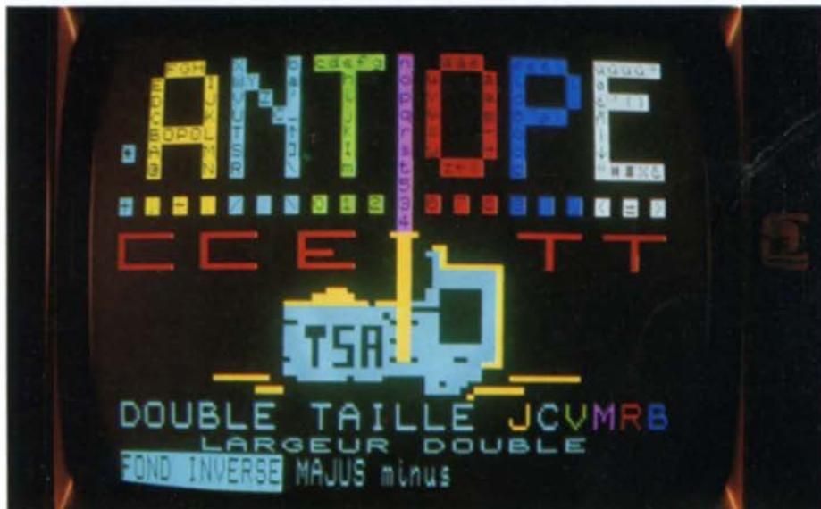
ANTIOPE ist ein Teletextsystem, welches von dem C.C.E.T.T. entworfen und im Sendenetz der TéléDiffusion de France (T.D.F.) erprobt wird.
